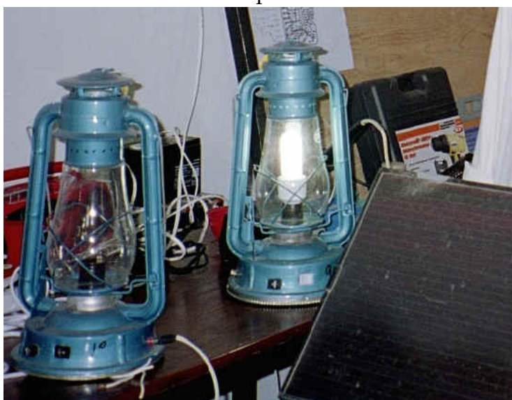
Solarlampe mit zugehörigem Solarpanel
